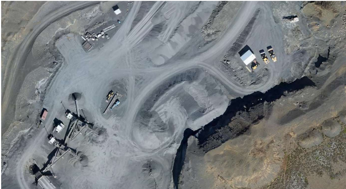
MYND 3.2 Yfirlitsmynd af vinnslusvæði ÍAV í Rauðamel. Aðstaða starfsmanna er hvíti skúrin til hægri á myndinni. Brjóturinn á myndinni gengur fyrir rafmagni, ekki olíu. Loftmynd tekin af EFLU verkfræðistofu í júlí 2018.
